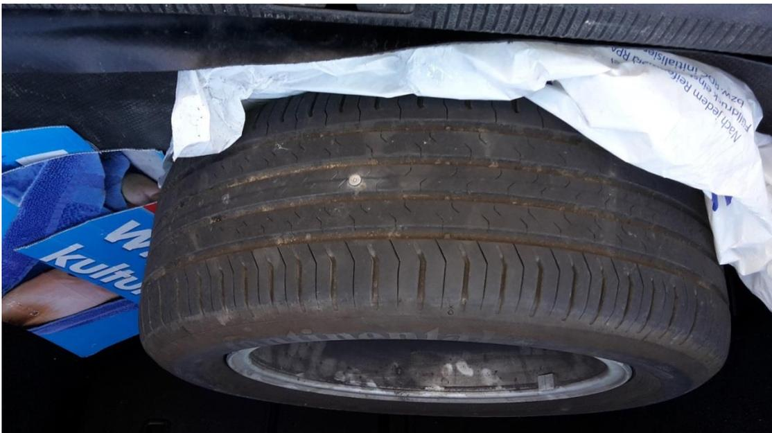
Bild des beschädigten Reifens mit eingebrachter Schraube
